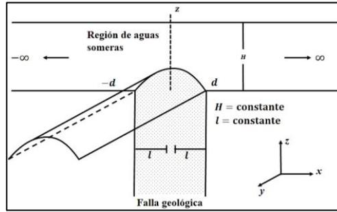
Figura 1. Sección transversal de aguas poco profundas en canal infinito con una perturbación en el fondo
