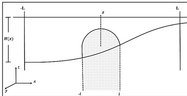
Figura 2. Sección transversal de aguas poco profundas cerca a la playa infinito con una perturbación en el fondo
